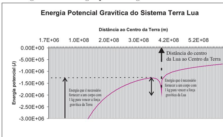
Para se viajar da Terra para a Lua é necessária fornecer à nave espacial energia suficiente para vencer a barreira de energia potencial gravítico do sistema nave+Terra+Lua.
